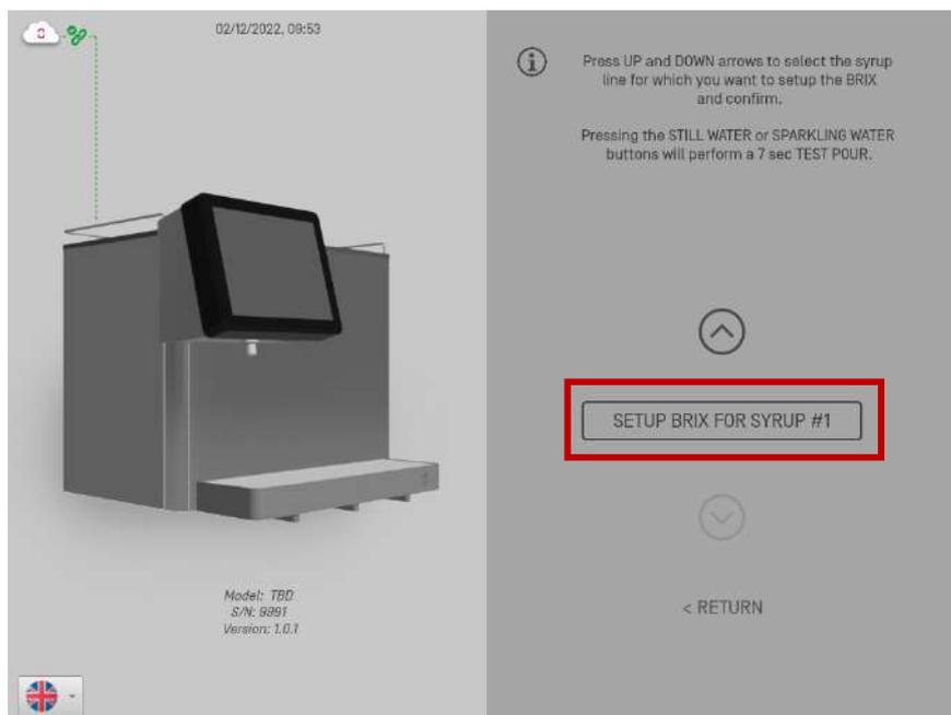
h. Avec un gobelet gradué / brix cup. Cliquez sur "Test pour". L'appareil distribuera du sirop pendant 7 secondes.
